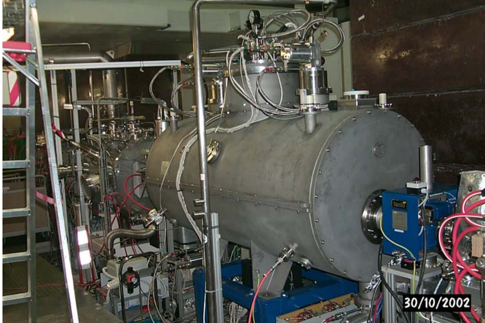
Рис. 9. Сверхпроводящий вигглер для накопителя ELETTRA.
