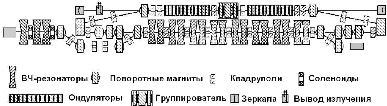
Рис. 12. Схема однопорожечного ускорителя-рекуператора и субмиллиметрового ЛСЭ.
