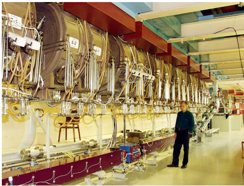
Рис. 13. Ускоритель-рекуператор 1-й очереди (медианная плоскость сделана вертикальной, чтобы можно было монтировать УР 2-й очереди, не прекращая работу на первой). Вверху – ускоряющая структура из 16 резонаторов. Внизу видны ондуляторы ЛСЭ.
