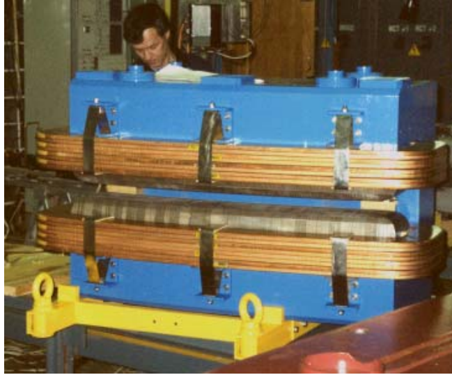
Рис. 7. Прототип дипольного магнита для SAGA.
